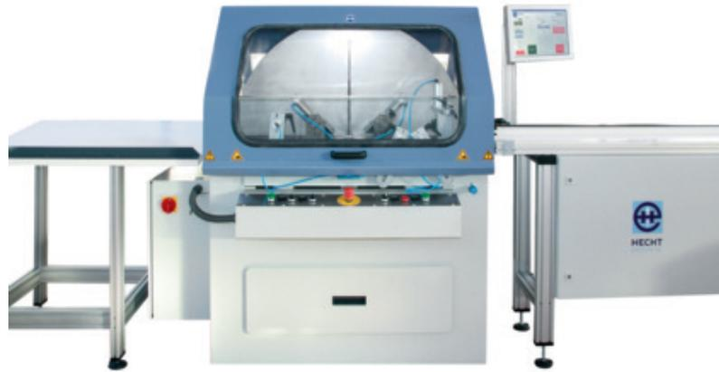
**> Mit dieser vollautomatischen Sägeanlage von Hecht Electronic bearbeitet Richter lighting technologies seit Kurzem alle Aluminiumprofile.**
